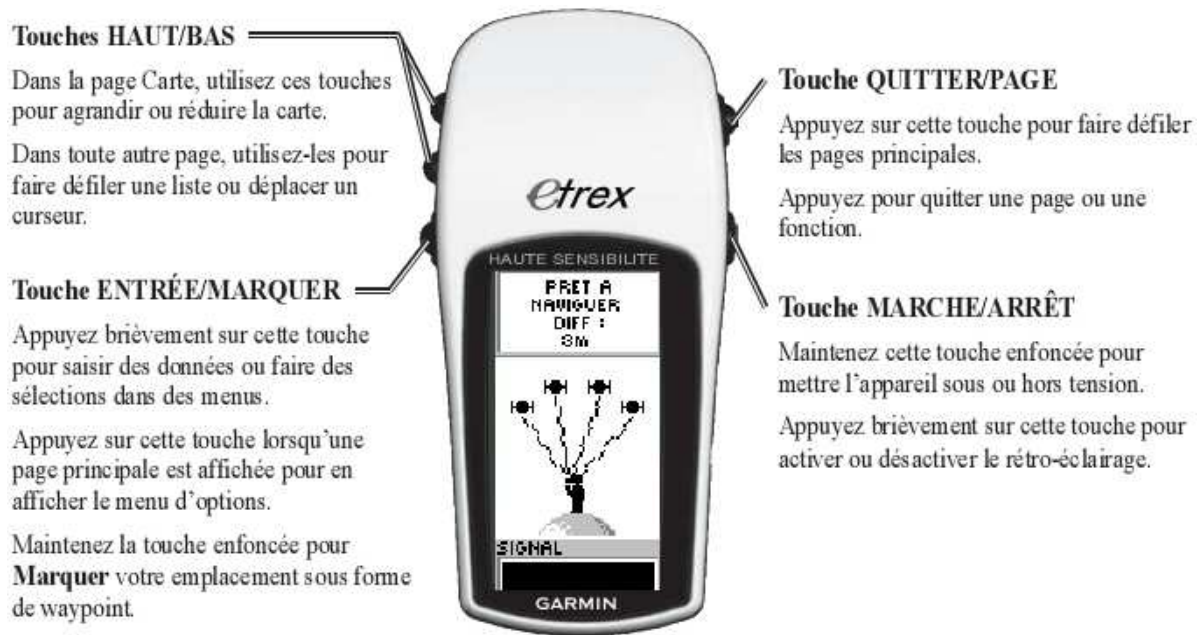
Figure 3: Fonctions clés du GPS accessibles en appuyant sur les touches de l'appareil
